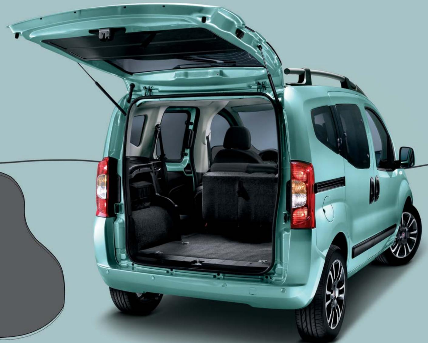
Il vano di carico di Nuovo Qubo è sorprendentemente ampio: con i sedili posteriori rimossi, può contenere fino a 2.500 litri. I sedili sono configurabili in 16 differenti posizioni, e quelli posteriori sono abbattibili e asportabili. Inoltre, a richiesta, il sedile anteriore passeggero può essere anch'esso ripiegabile, per essere posizionato a livello del piano bagagliaio, consentendo così il trasporto di carichi lunghi fino a quasi 2,5 metri.
